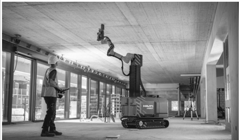
그림 4 천장타공작업 로봇 - 자이봇
