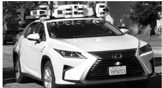
그림 3 | LiDAR등의 자율주행 기능을 탑재한 애플의 테스트 자동차
