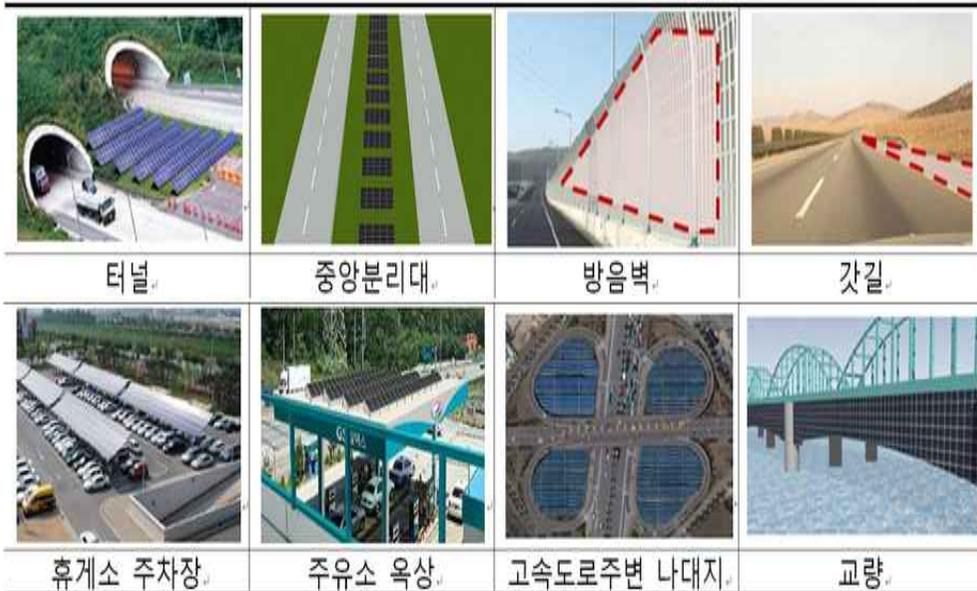
[그림 4-6] 녹색도로내 태양광 설치 가능 요소
